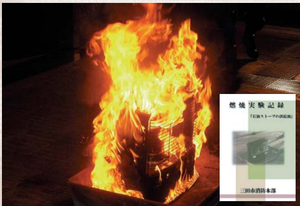
出火後は炎が急激に拡大し初期消火は困難(DVD映像より)
